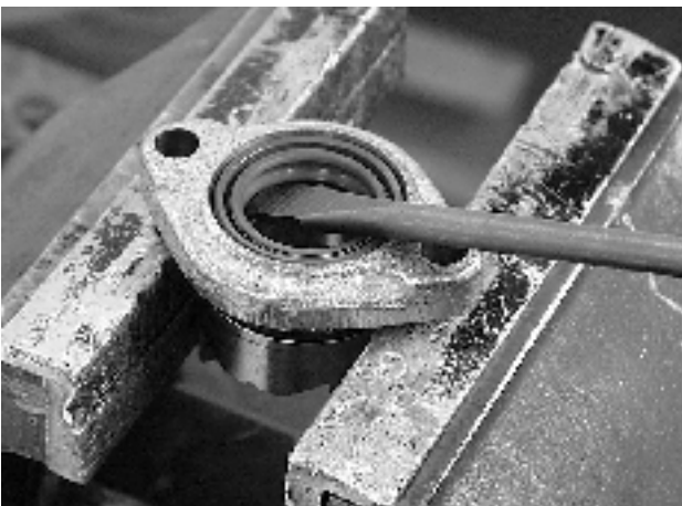
7. Déposer la bague d'étanchéité à l'aide d'un tourne-vis. Nettoyer toutes les pièces du mécanisme d'inversion de marche et vérifier le degré d'usure. Remplacer les pièces si nécessaire.
