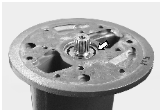
70. Ajouter l'épaisseur de cale calculée et le joint sur le plan de fixation du carter d'engrenage.
