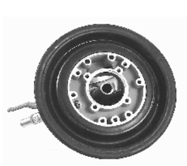
71. Monter le soufflet caoutchouc sur le carter supérieur d'engrenage.
